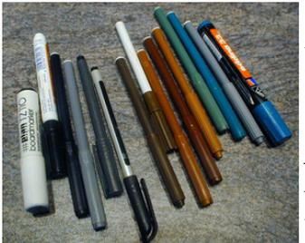
Filzstifte in unterschiedlichen Farben werden für die Nachbehandlung der Schnittkanten verwendet.
