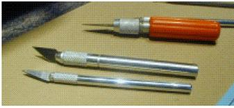
Zum groben Ausschneiden der einzelnen Teile dienen diverse Scheren. Arbeiten an den Modellteilen erfolgen mit scharfen Cutter-Messern, Skalpell oder ähnlichen Werkzeugen.
