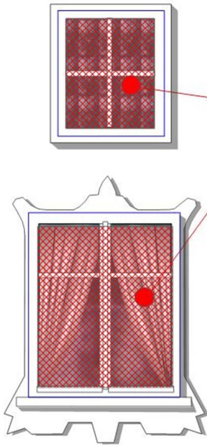
Bei Fenstern im Fachwerk- und Blockbereich, die für die Beleuchtung vorgesehen sind, nur den rot schraffierten Bereich in der Außenschicht ausschneiden und mit dem entsprechenden blau gekennzeichneten Teil aus Papier überkleben. Der Blockbereich ist in aller Regel der Wohnbereich und der Fachwerkbereich (oberes Stockwerk) der Schlafbereich.
